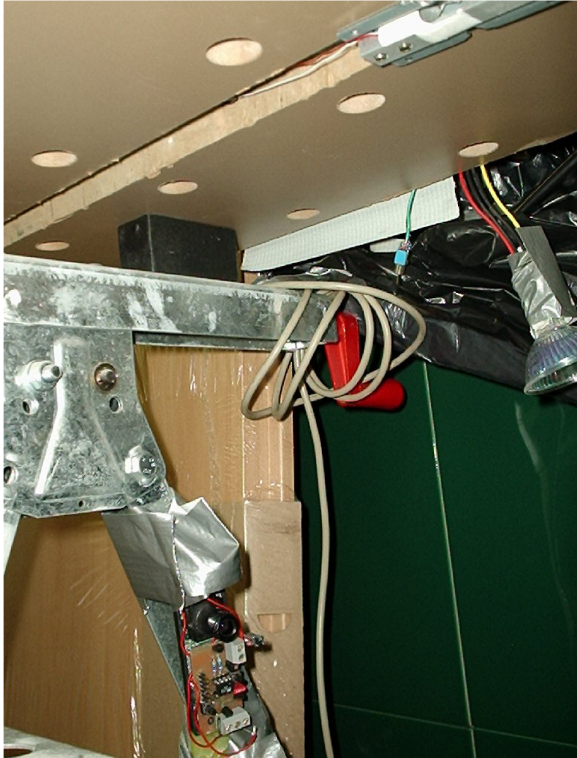
I7: Unterseite des Teststandes. Oben ist der Biegebalken mit aufgeklebten DMS zu sehen. Rechts eine Halogenlampe, welche als Last für das Netzteil dient. Links unten ist die Kamera zu sehen.
