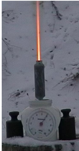
11: Beispiel einer Schubmessung mit Hilfe einer Waage
