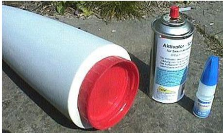
Der rote Deckel wurde mit Cyanacrylat (Sekundenkleber) und Aktivator (zum schnellen Aushärten) auf der Sperrholzscheibe der Spitze mittig fixiert. Eine zweite Scheibe aus Sperrholz wurde aufgeklebt und mit Schrauben gesichert. Die Aufnahme der Schockleine ist aus einfachem Fahrradseilzug. Dieses Stahlseilchen ist in der Spitze und mit den Holzscheiben verankert und verklebt. Schliesslich muss die Spitze ja auch am Fallschirm hängen...
