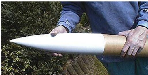
Die Spitze wird eingesetzt, passt. Somit habe ich eine super Führung innerhalb des Rohres mit einer ganz einfachen Lösung der Nutzlastkammer gefunden.
