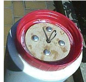
Hier erkennt man sehr schön wie die Leine mit der Spitze verbunden und durch die Nutzlastkammer, welche sogleich als Führung im Körperrohr dient, durchgeführt ist. Somit hängt die Spitze nicht an der Nutzlastkammer, sondern umgekehrt.
