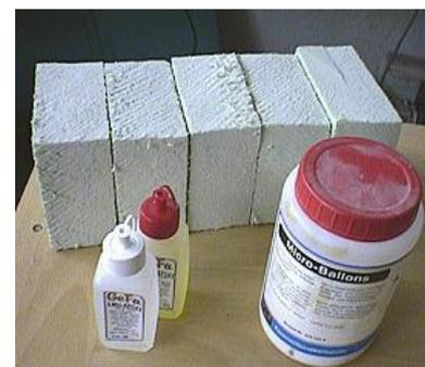
Zusammengeklebt wird mit 5 Min Epoxi und Microballons. Im Bild rechts sieht man das Ausfräsen einer Scheibe mittels Dremel und Oberfräseeinrichtung. Diese Scheibe ist der Abschluss der Spitze zum Körperrohr hin. Daran wird später die Fallschirmhalterung geschraubt und noch etwas mehr...
