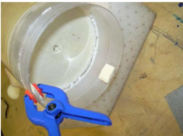
Mit der Schablone, mit der bereits am Anfang die Löcher in den Ring am Druckkörper angezeichnet wurden, werden jetzt die Löcher zur Verbindung des Fallschirmmoduls mit der Spitze angezeichnet und kleine Holzreste hinter die Löcher geklebt. Nach dem trocknen des Klebers die Löcher durchbohren.
