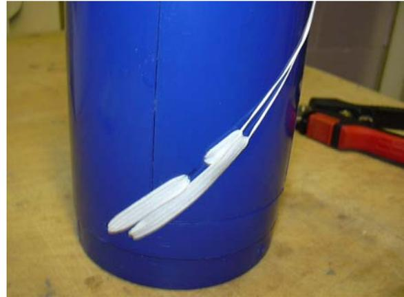
Ein Stück Schnur wird jetzt durch das Gummi gezogen und zu einer Schlaufe gebunden. Die Schlaufe sollte so lang sein, dass das Gummi stramm gezogen ist wenn die Schlaufe im Timer eingehängt wird.
